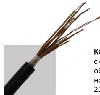
**КФШР** - кабели управления многожильные с фторопластовой изоляцией в резиновой оболочке. Предназначены для работы при номинальном переменном напряжении до 250 В частоты до 1000 Гц и постоянном напряжении до 350 В.
