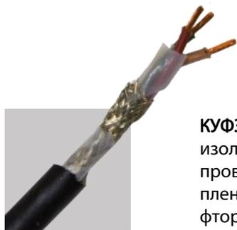
**КУФЭФС** - кабель управления с фторопластовой изоляцией, в общем экране в виде оплетки проволоками или обмотки фольгированной пленкой в резиновой оболочке на основе фторкаучука.
